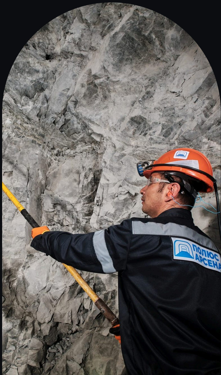
ОБОРКА ЗАКОЛОВ · ОСМОТР КРОВЛИ И БОРТОВ
