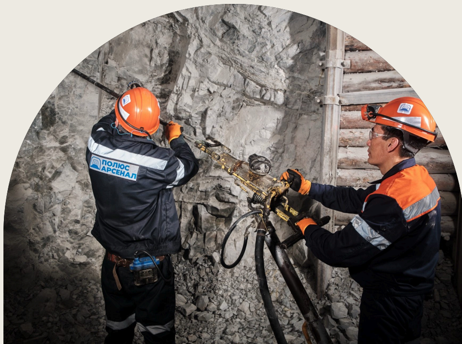
ПЕРФОРАТОР В РАБОТЕ · ЗАБОЙ
